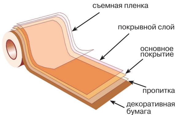
Подоконники MÖLLER имеют высококачественное покрытие многослойным ламинатом ELESKO-PLUS ON TOP, разработанное на основе акрилатовых смол, производится по технологии отверждения поверхности электронным лучом, что придает подоконникам дополнительные преимущества, такие как стойкость к царапинам, ударостойкость, устойчивость к солнечным лучам и т.д.
